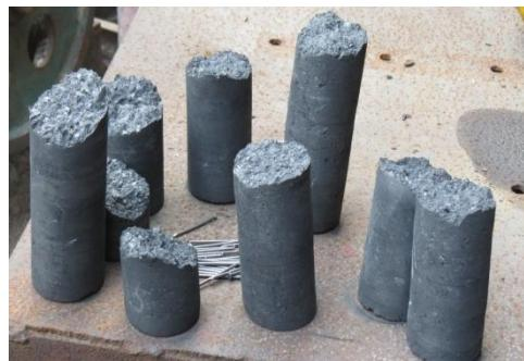
2010 年原告重庆某 A 公司向被告 B 公司购买了 98 吨碳素电极。原告购买被告的碳电极产品用于生产时, 被告生产的碳素电极出现大范围的频繁断掉, 螺口无法拧入等严重质量问题, 造成原告数次停产, 给原告造成巨大经济损失。因此原告起诉被告要求赔偿。重庆某法院审理此案的过程中, 被告对卖给原告的碳极质量问题予以否认, 一时间, 争议焦点集中在: 涉案炭素电极产品的质量是否合格, 如不合格是哪方原因造成?
