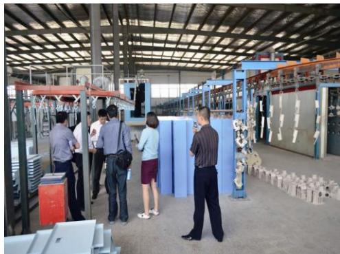
山东省某市人民法院委托华碧司法鉴定所对涉案前处理生产线是否符合双方合同要求,是否达到双方约定的目的进行物证鉴定。华碧司法鉴定所根据相关文件鉴定出涉案生产线具备通过双方约定尺寸的工件的能力;涉案生产线加工的工件中存在表面不平整、有锈迹、有异物,磷化膜层结晶不致密、不均匀的物证特征,未达到双方约定的要求,生产线质量不合格,并出具了相关物证鉴定意见书。
