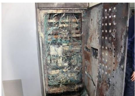
上海某律师事务所委托华碧司法鉴定所对某(太仓)科技有限公司配电房电气火灾的原因进行物证鉴定。华碧司法鉴定所根据相关文件对其进行了一次全面的分析鉴定,发现所鉴定配电柜的1根电缆线的端部螺丝固定处存在一次短路熔珠的特征物证,与本案配电房电气火灾存在因果关系。该电缆线末端螺丝固定处与铁支架之间的
