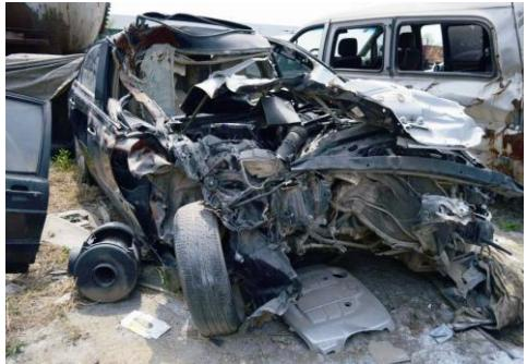
南京市\*\*区人民法院委托华碧司法鉴定所对涉案车辆在事故发生的状态下,安全气囊是否应该打开进行物证鉴定。华碧司法鉴定所根据安全气囊展开条件说明函、《关于车架号码为\*\*的\*\*车辆技术分析报告》等相关文件对涉案安全气囊进行了全面的分析鉴定。鉴定出涉案车辆在事故发生时,碰撞物体为正在运行中的挂车后部,属于钻撞,碰撞加速度偏小,安全气囊未达到起爆条件,且涉案车辆的驾驶员未系安全带,会造成驾驶员前移,为保护驾驶员会抑制安全气囊起爆,涉案车辆的安全气囊在事故中未起爆,系使用方和碰撞环境未达到起爆条件的综合原因造成,安全气囊质量合格,并出具了相关物证鉴定意见书。
