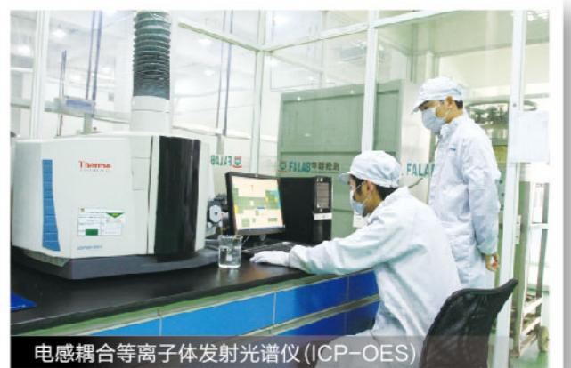
电感耦合等离子体发射光谱仪(ICP-OES)
