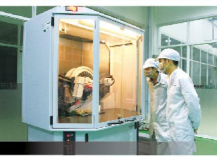
扫描电子显微镜与能谱仪 SEM/EDS
